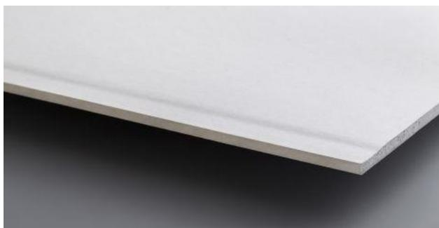
PREGYPLAC PLUS BA13 è una lastra di gesso rivestito standard con aggiunta di fibre di vetro nell'impasto, dello spessore di 12,5 mm, a bordi assottigliati, per la realizzazione di pareti, contropareti, controsoffitti, rivestimenti o rettifica della planarità di pareti verticali o inclinate. **NORMATIVA DI RIFERIMENTO: UNI EN 520 TIPO DI LASTRA secondo ITT (Initial Type Test): A**
